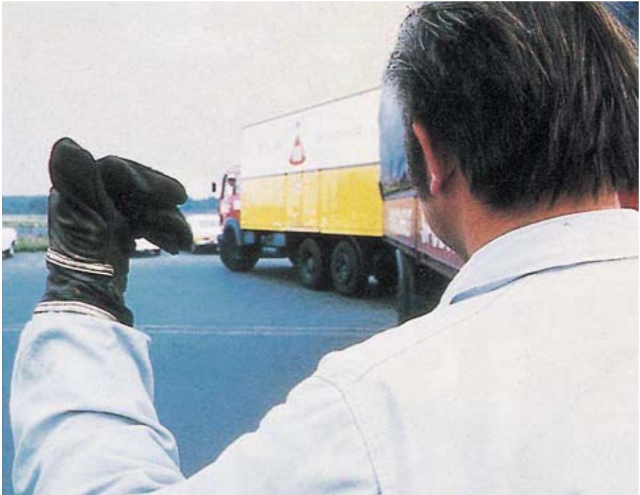
Bild 9-2: Einweiser beim Rückwärtsfahren
