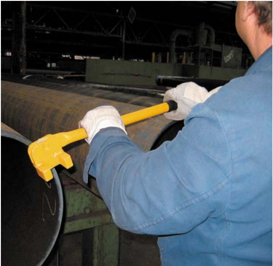
Bild 4-4: Bewegen von Material mit einem Rohrschlüssel
