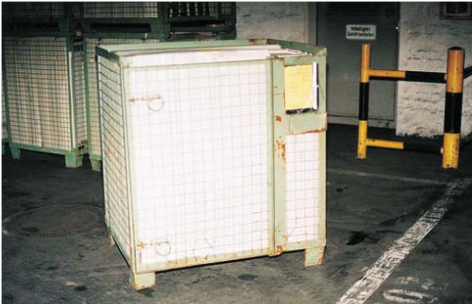
Bild 11-1: Gitterboxpalette gemäß DIN 15155
