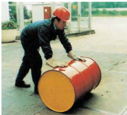
Bild 1-3: Beim Rollen von Fässern nicht an die Fassränder greifen
