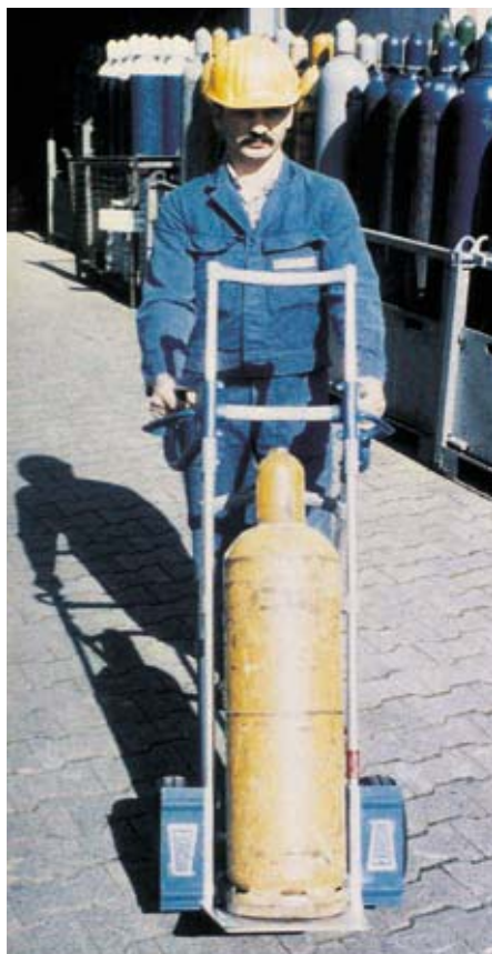
Bild 5-2: Eine Sonderbauform der Stechkarre ist die Flaschenkarre
