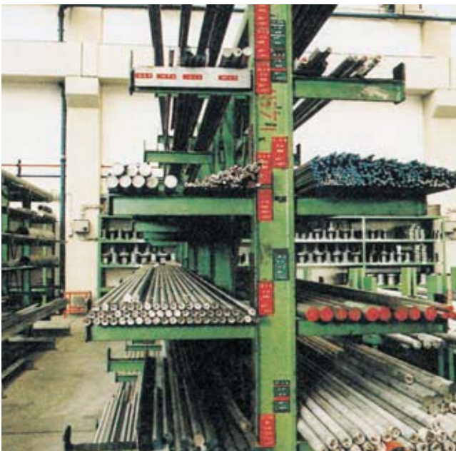
Bild 13-1: Gestapelte Stangen und Rohre gegen Wegrollen und Herab- fallen gesichert
