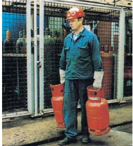
Bild 3-7: Beim Handtransport den Körper möglichst gleichmäßig belasten
