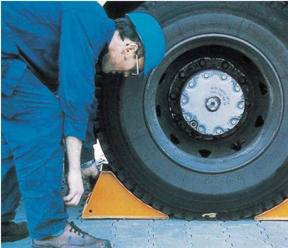
Bild 9-1: Festlegen des Fahrzeuges mit Unterlegkeilen am Rad
