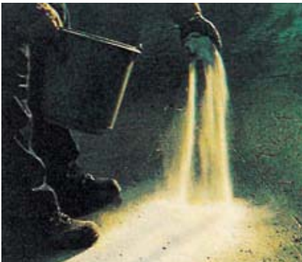
Bild 7-7: Ausgelaufene Öl- und Schmierstoffe lassen sich durch Aufsaugmittel schnell und wirksam entfernen
