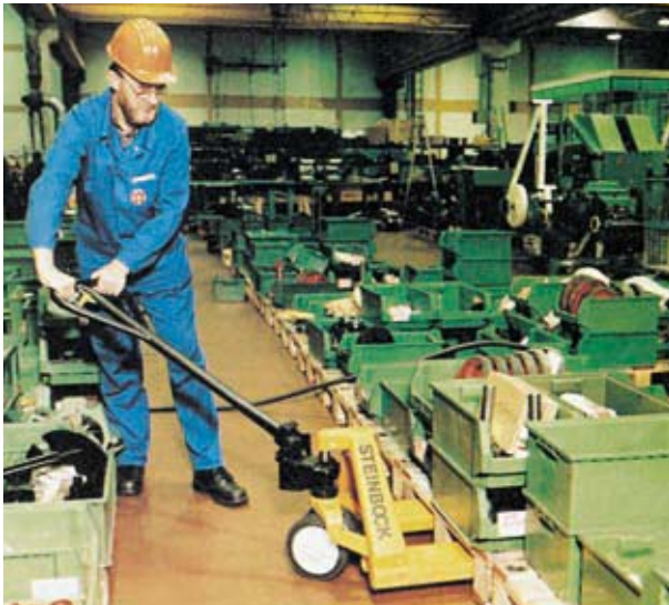
Bild 5-7: Hydraulisch betriebiger Handgabelhubwagen mit Bremsenrichtung
