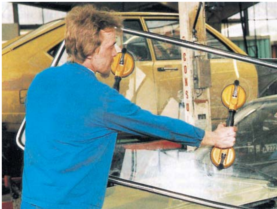
Bild 4-1: Saugtragegriffe für glatte und ebene Teile
