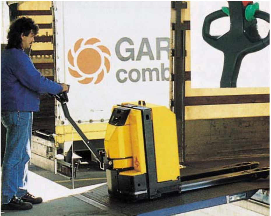
Bild 6-1: Mitgänger-Flurförderzeug mit sicherheitstechnisch und ergonomisch günstig gestaltetem Steuerungshandgriff
