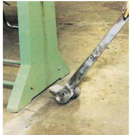
Bild 4-3: ... oder als Rollknippstange vervielfachen die Körperkraft
