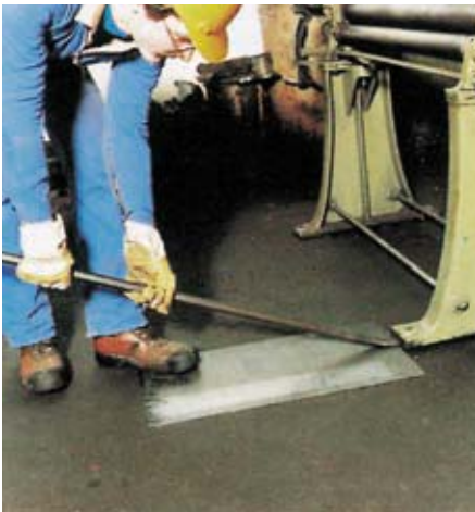
Bild 4-2: Knippstangen als Hebel in einfacher Ausführung ...
