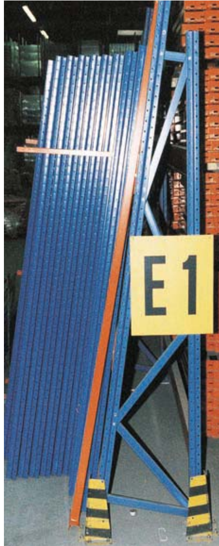
Bild 12-1: Sicherung hochkant gelagerter Bleche
