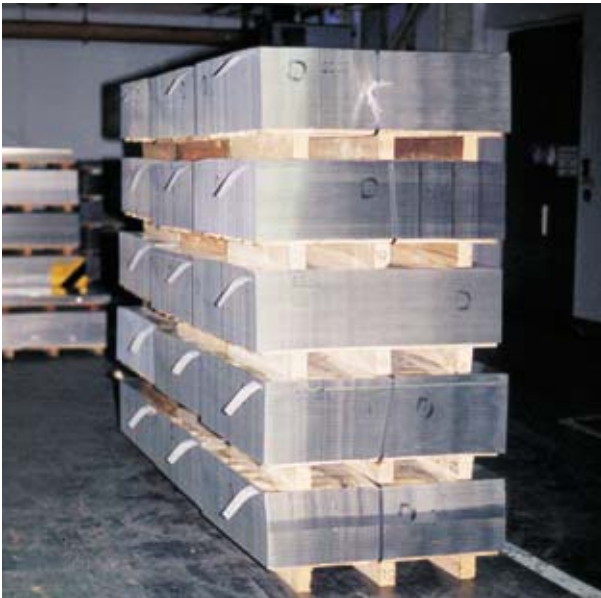
Bild 11-2: Palettenstapel mit stabilem Ladegut (Blechtafeln)
