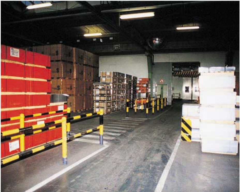
Bild 7-1: Gute Kennzeichnung und Gestaltung von Wegen sind Voraussetzungen für den sicheren innerbetrieblichen Transport und Verkehr
