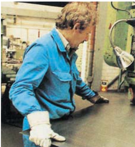
Bild 17-3: Beim Hantieren mit scharfkantigen Werkstücken – immer Schutzhandschuhe tragen
