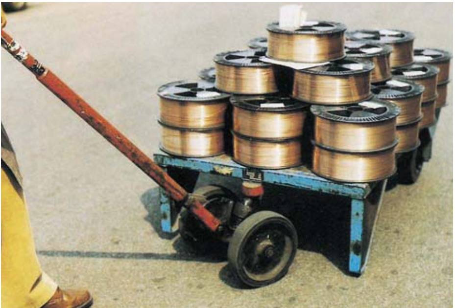
Bild 5-4: Rollpritsche und Heberoller mit Aushebesicherung
