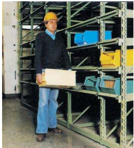
Bild 3-8: Bei beidhändigem Handtransport die Last nahe am Körper mit flachem Rücken tragen
